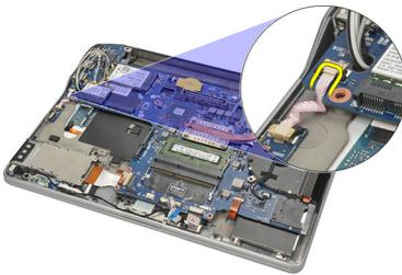
10. Remova o parafuso que prende a chave do dispositivo de rede sem fio.
