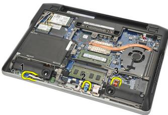
6. Vire o computador. Com o uso de um estilete plástico, solte gentilmente o canto superior esquerdo do apoio para as mãos. Deslize o estilete plástico
