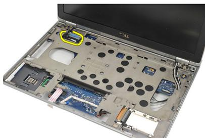
21. Vire o computador e desconecte os seguintes cabos da placa de sistema:
