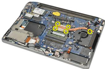
11. Remova o dissipador de calor e o conjunto do ventilador da CPU.
