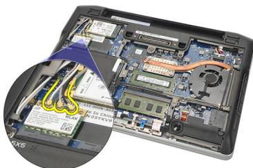
5. Remova o parafuso que prende a placa WLAN ao computador.
