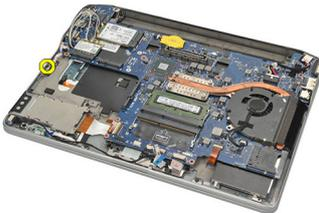
11. Remova a chave do dispositivo de rede sem fio.
