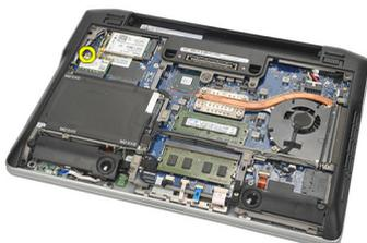
6. Remova a placa WLAN do computador.
