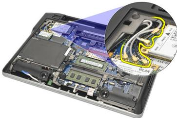
8. Vire o computador e levante-o levemente. Puxe os cabos de antena da rede sem fio pela abertura no computador e retire-os do porta cabo.
