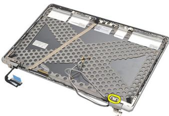
10. Solte o cabo da rede sem fio de dentro da ponteira da dobradiça.
