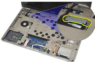
11. Desconecte o cabo de LVDS da placa de sistema.
