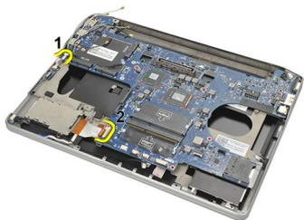
22. Remova os parafusos que prendem a placa de sistema.
