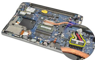
10. Levante e remova o conector da entrada de alimentação CC do computador.
