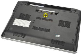
4. Deslize a tampa da base em direção à traseira do computador e remova-a.
