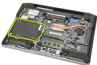
6. Remova os parafusos do suporte do disco rígido.
