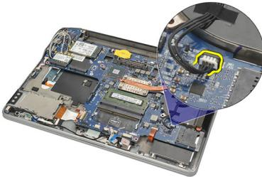
10. Solte os parafusos prisioneiros do dissipador de calor e remova o parafuso do ventilador da CPU.
