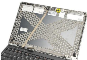
6. Remova a câmera e/ou microfone ao desconectar o cabo na tampa superior da tela.
