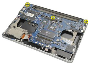
23. Levante o lado direito da placa de sistema juntamente com os conectores USB e HDMI e puxe os cabos de antena pela abertura na placa de sistema.
