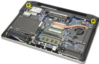
7. Desconecte todos os cabos de antena da rede sem fio.
