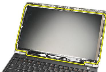
6. Destaque a fita adesiva que prende a conexão de LVDS (Low-Voltage Differential Signaling [Sinalização diferencial de baixa tensão]) ao painel da tela.
