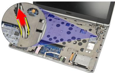
9. Remova os parafusos do suporte de LVDS (Low-Voltage Differential Signaling [Sinalização diferencial de baixa tensão]).
