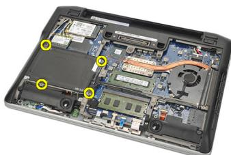
5. Use a aba em Mylar para levantar o disco rígido e removê-lo do computador.
